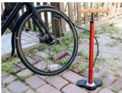
Una bomba de bicicleta calienta el aire que comprime... ¡se puede comprobar al tocar después la válvula de inflado!
